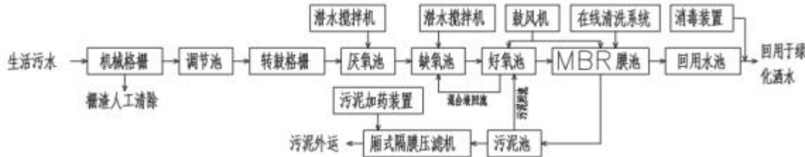
图 2-5 中部风井场地生活污水处理工艺流程图
